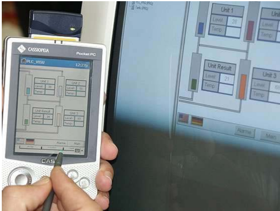
Abbildung 24: Einfache Portierung eines Soft-SPS Programms von Windows auf einen PocketPC
